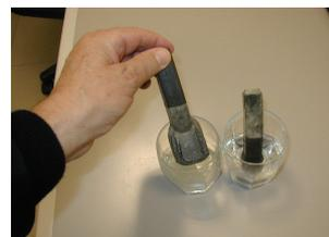
Dopo 24 ore il rigonfiamento del WAM 101 HD (opaco) è ulteriormente aumentato, mentre il WAM 101 WATER RESISTANT (lucido) appena comincia a deformare il profilo
